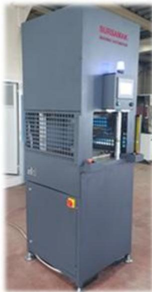
Alle hydraulischen und elektrischen Komponenten unserer Pressen sind in sich abgeschlossen, sodass sie nur minimalen Platz in Ihrem Produktionsbereich beanspruchen.
